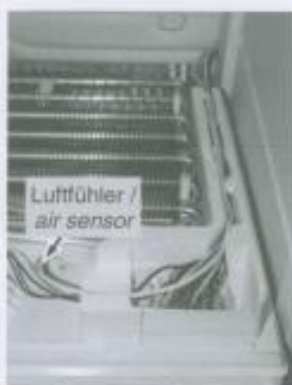
Fig. 5 Luftfühler durch die Verdampferabdeckung ziehen und aus dem Styroporkanal ziehen.
