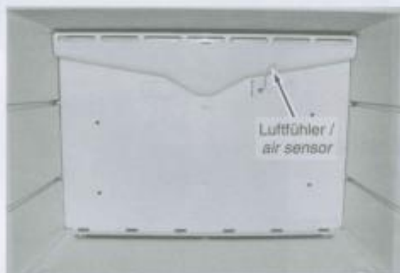
Fig. 3 Befestigungsschrauben entfernen. Modul oben vorsichtig etwas nach vorne ziehen und anschließend nach unten schwenken.
